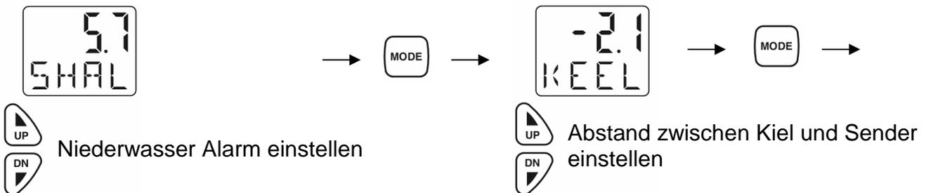
Kleinste Einstellung für Niederwasseralarm **2m** höchste Einstellung für Tiefenwasseralarm **99m**. Für keinen Alarm **0** eingeben.
